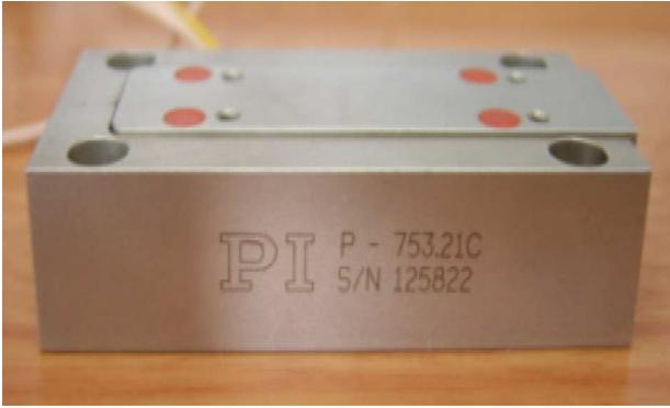
Fig. 4. Piezoelectric actuator (PZT-753.21C).
